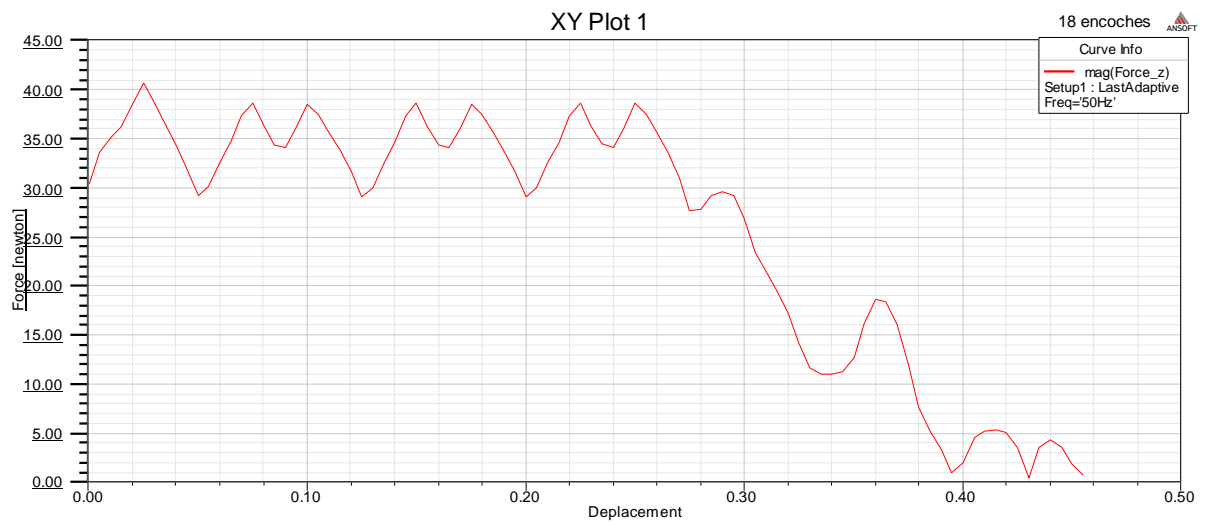
Figure IV.31. « La force de poussée en fonction de déplacement en utilisant l'induit en cuivre.»
