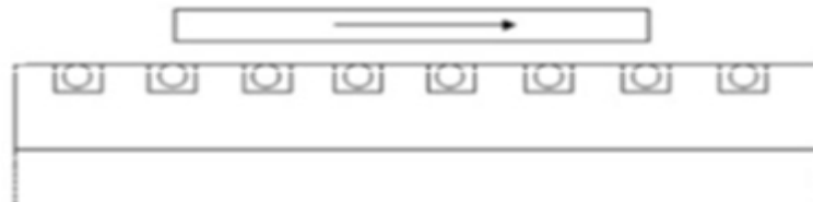
Figure I.12. « Machine linéaire à stator long, simple inducteur ».
