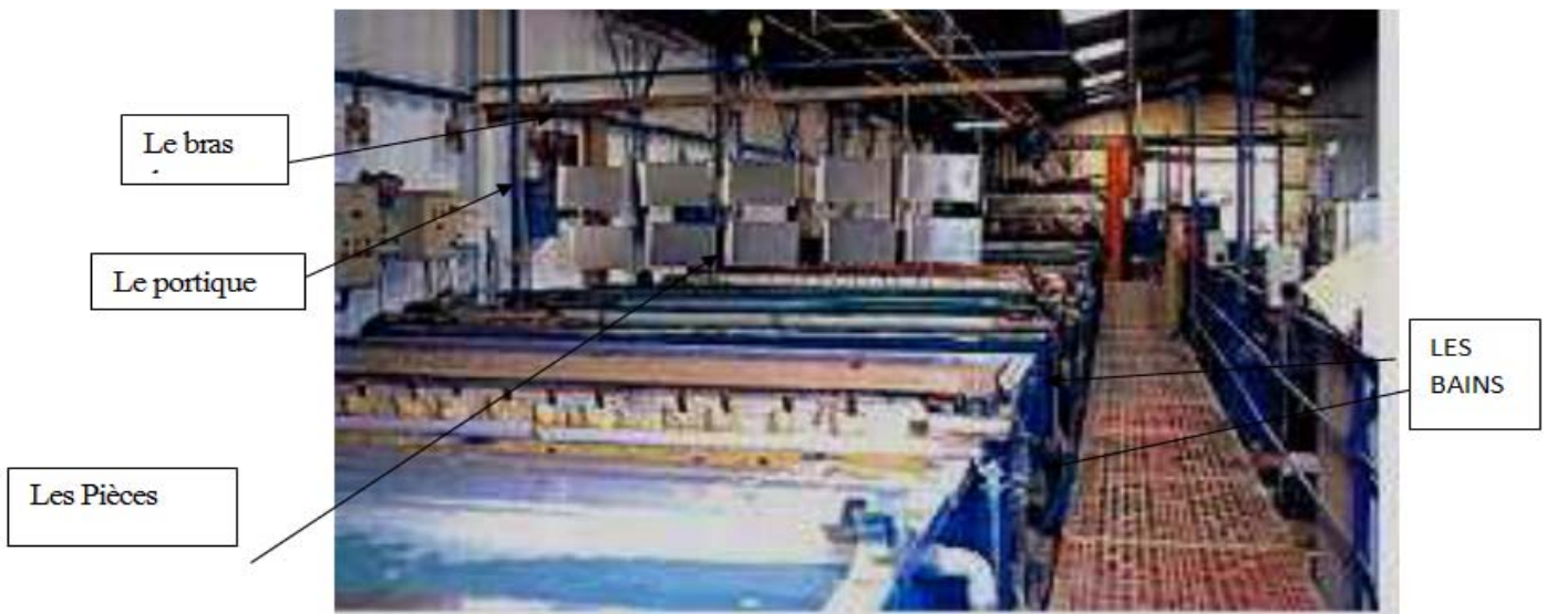
Figure .I .1 : représentation de la station de décapage par immersion
