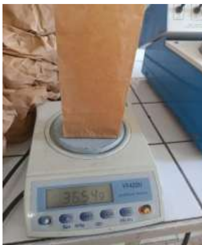
Figure 23. Balance électronique de la marque YP402 N utilisée dans l'expérimentation.
