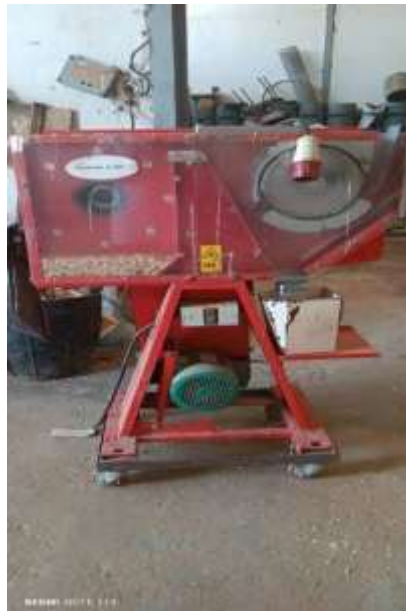
Figure 28. Batteuse à épis utilisée pour extraire les graines
