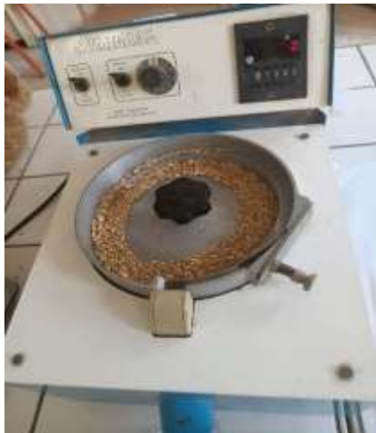
Figure 22. Compteur automatique de la marque de NUMIGRAL utilisé dans l'expérimentation.
