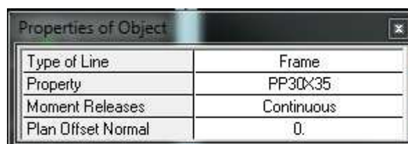
Fig IV.23) création des poutres
