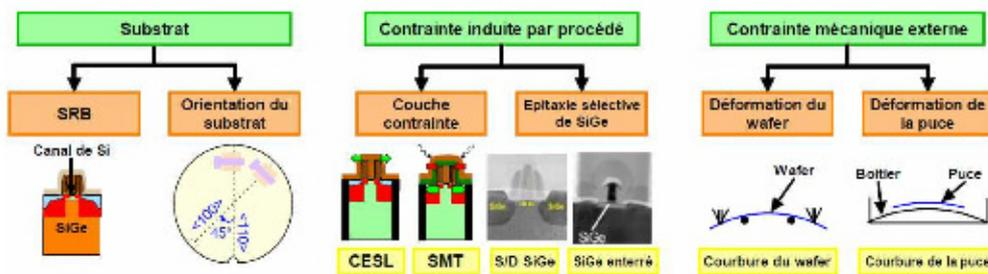
FIGURE I.8.: Différentes technologies de contraintes mécaniques
