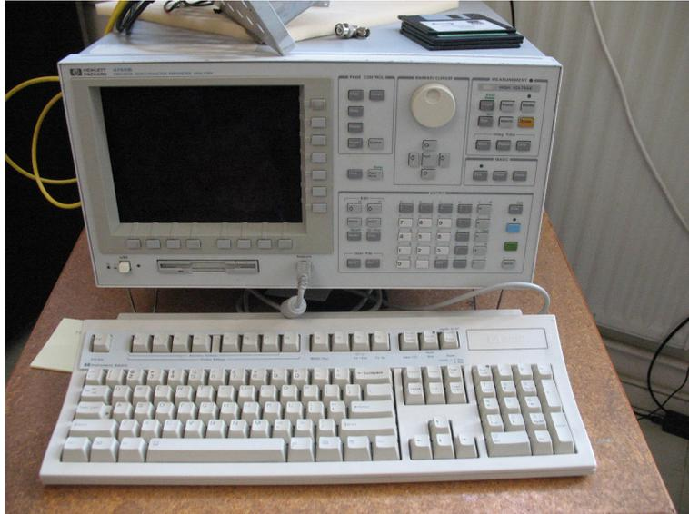
FIGURE III.4.: Traceur de courbe HP4556B utilisé pour les mesures en courant continu.
