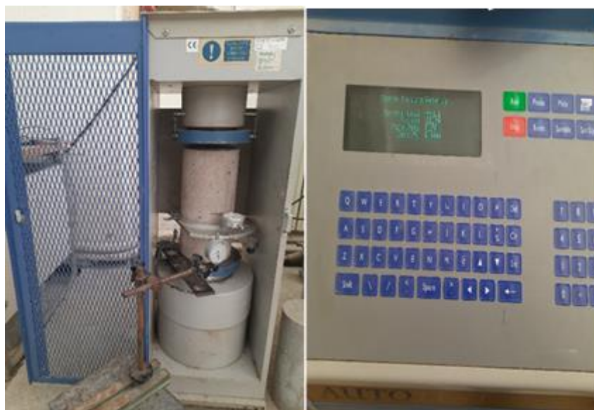
Figure IV.14 écrasement de l'éprouvette
