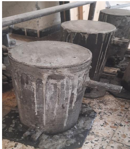
Figure IV.6 Eprouvettes après coulage.
