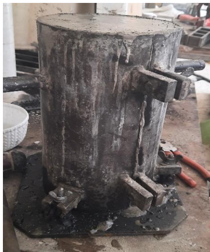
Figure IV.7 : Démoulage de l'éprouve cylindrique.
