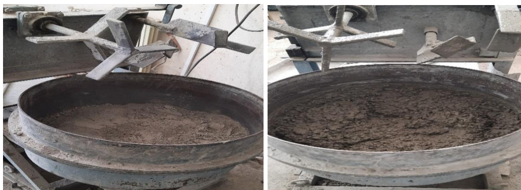
Figure IV.1 Malaxage de béton témoin.
