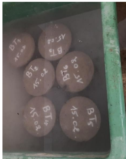
Figure IV.8 : Eprouvettes conservées dans l'eau.
