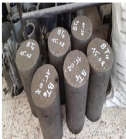
Figure IV.11 avant cycle de chauffage-Refroidissement.
