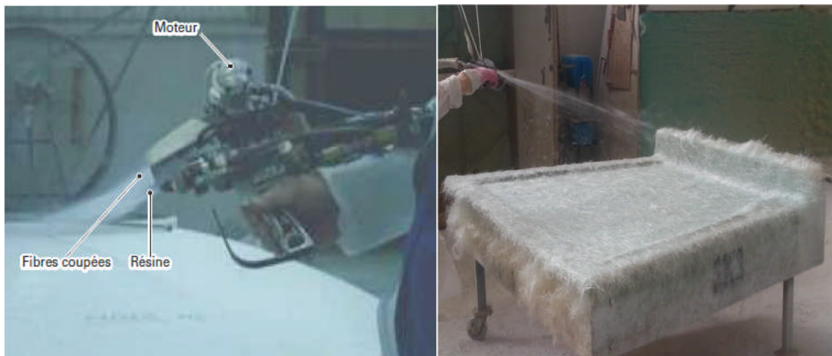
Figure I.17 : Principe du moulage par projection simultanée
