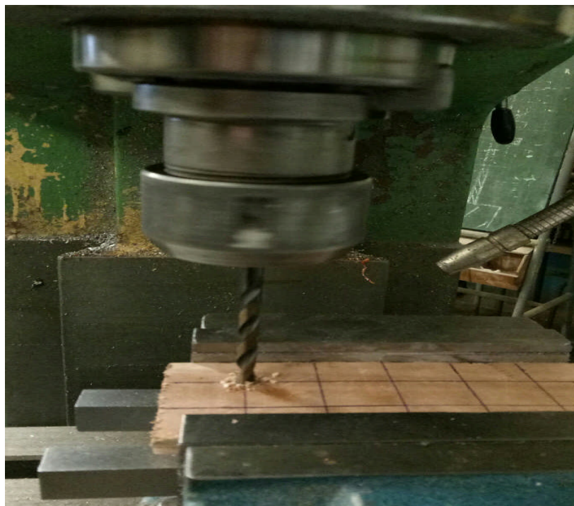
Figure II.1 : Perçage par enlèvement de matière
