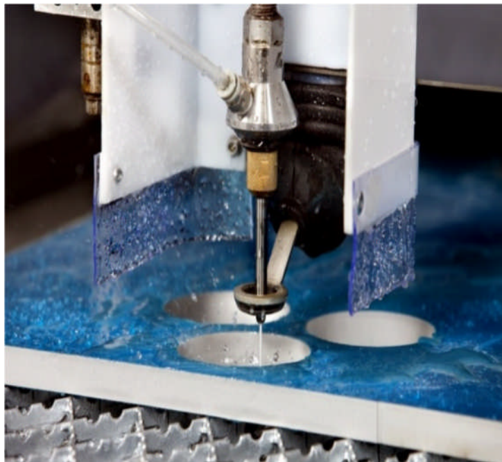
Figure II.2 : Perçage par jet d'eau à haute pression
