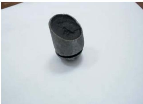
**Figure III.2 :** Vue du lingot obtenu au four à induction.
