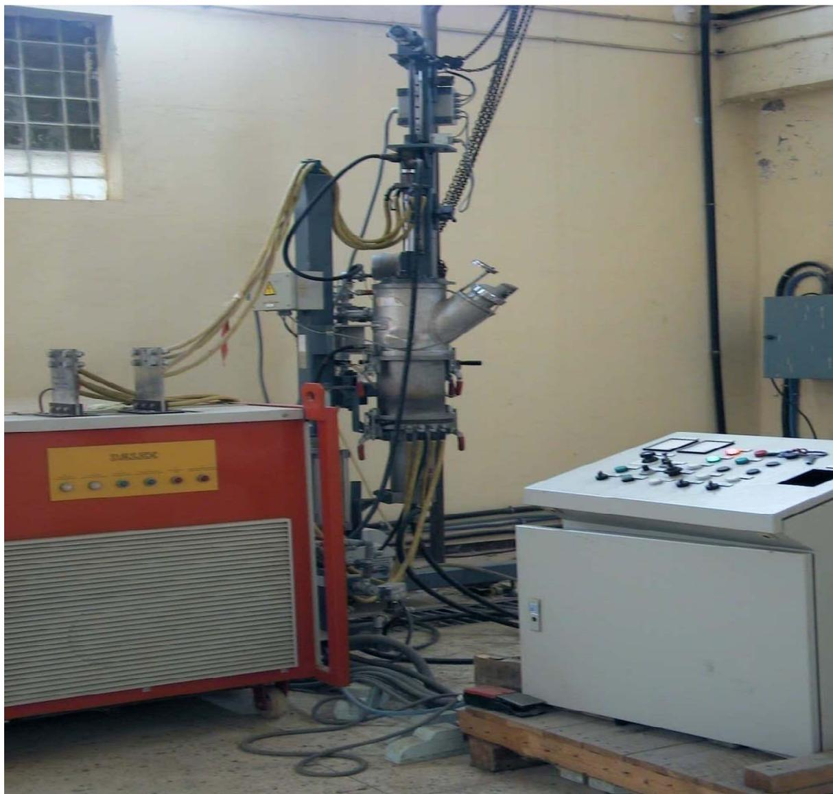
**Fig. III.5 :** Four à Arc à Electrode consommable
