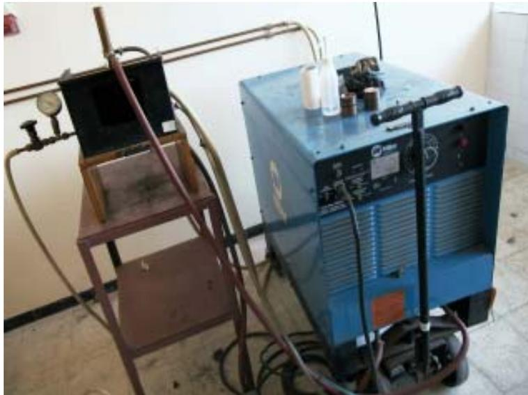
*Figure III.4 : Vue d'ensemble du Four à bouton.*
