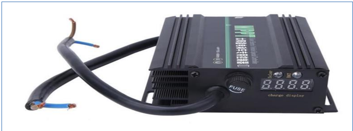
Fig. III.7 : Régulateur du kit solaire PV
