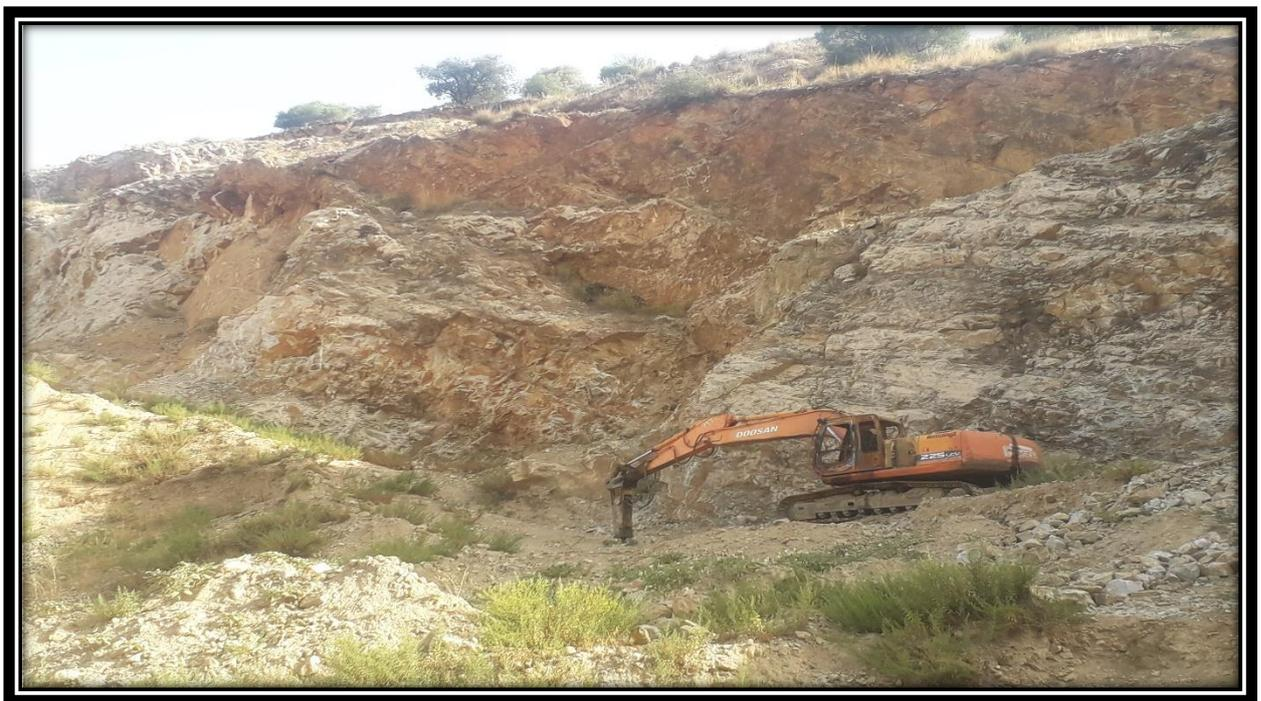
**Figure 25** : mode d'extraction par brise roches
