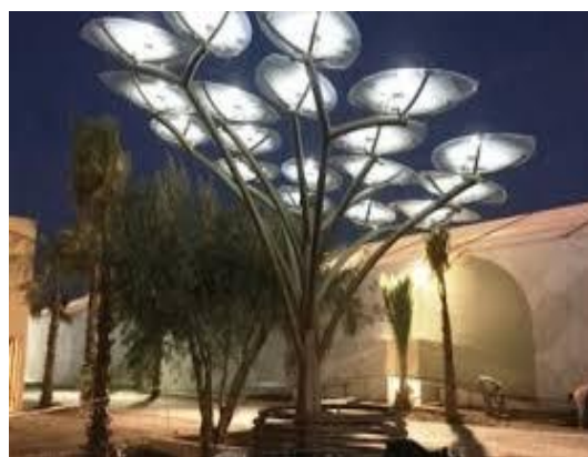
Figure 23 : Arbre solaire photovoltaïque (eTree) [b7]
