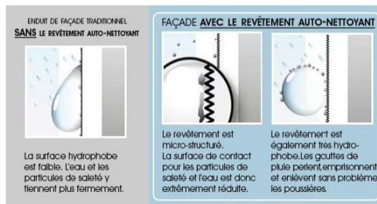
Figure 12 : Façade sans et avec le revêtement autonettoyant [a9]
