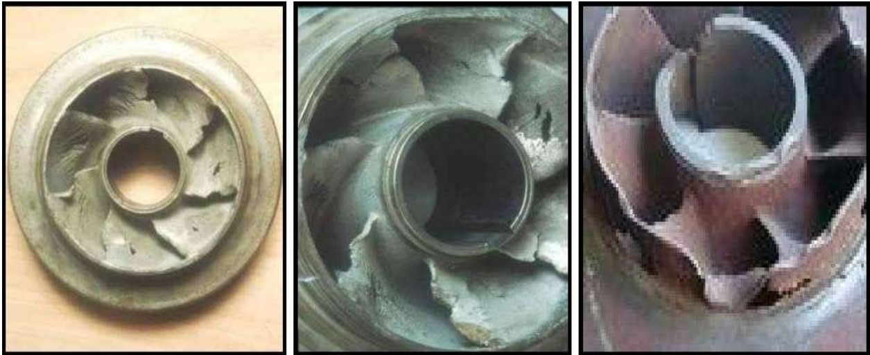
Figure V-10 : photos illustre le phénomène de cavitation sur les aubes d'une pompe centrifuge.
