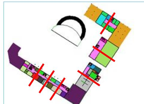
Figure 105: Les joints dans notre projet /RDC
