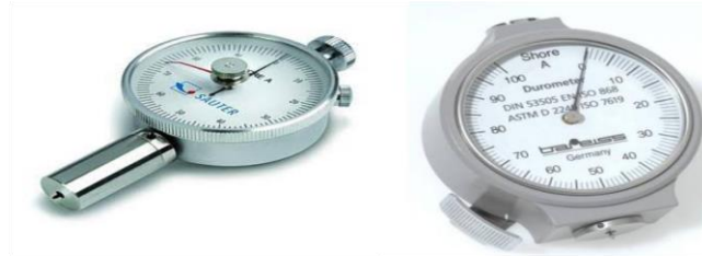
Figure 31 : Duromètre Shore A et D [2]
