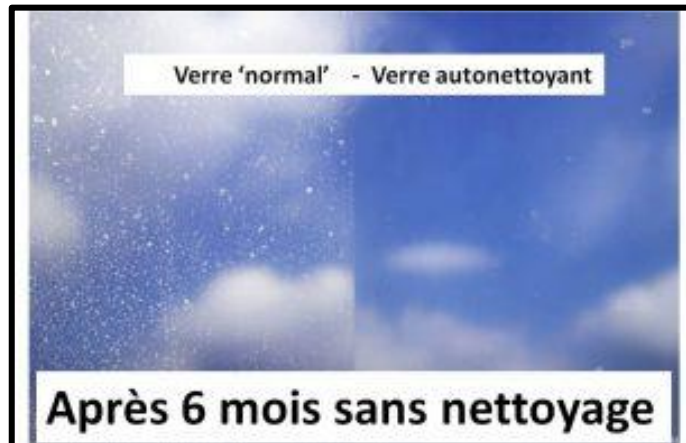
Figure 67: Comparaison entre la surface d'un verre autonettoyant et celle d'un verre classique après un spray d'eau
