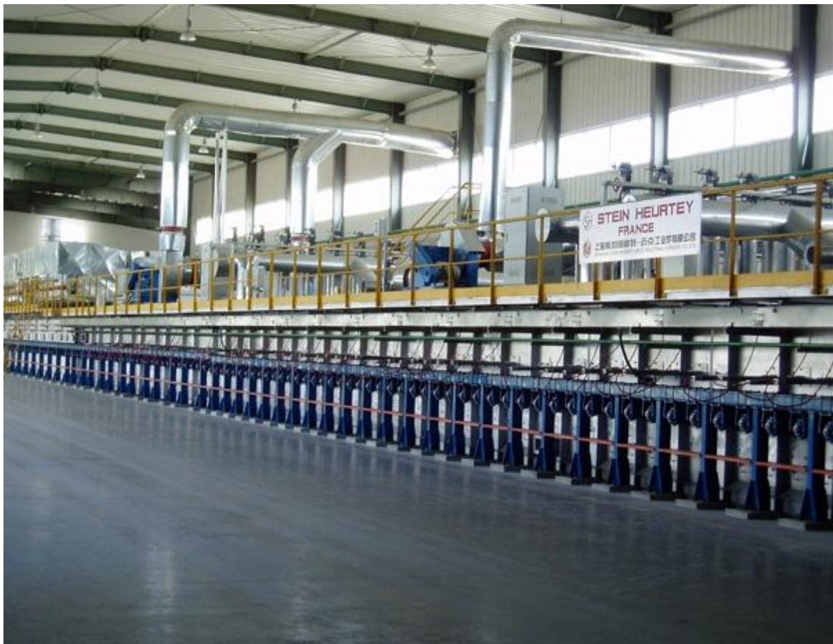
Fig.I.7 : L'étenderie de la float line
