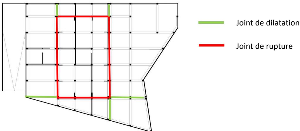
Figure 116 Plan de structure de la banque
