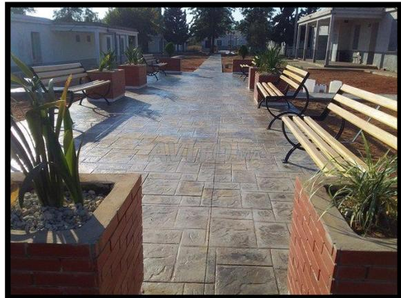
Figure 130 Revêtement de sol en béton imprimé
