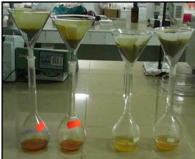
Figure 07 : Filtration des extraits aqueux et éthanoïques
