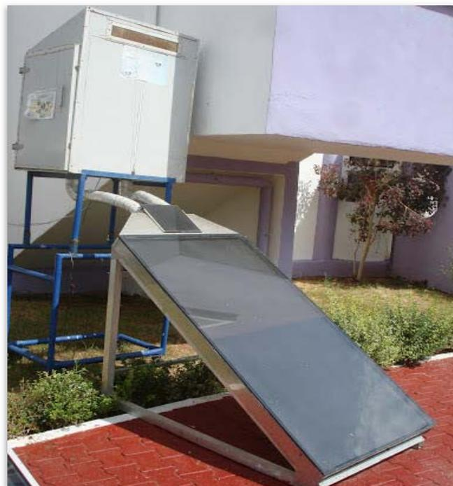
Figure I-19: Séchoir solaire indirect destiné au séchage des PAM
