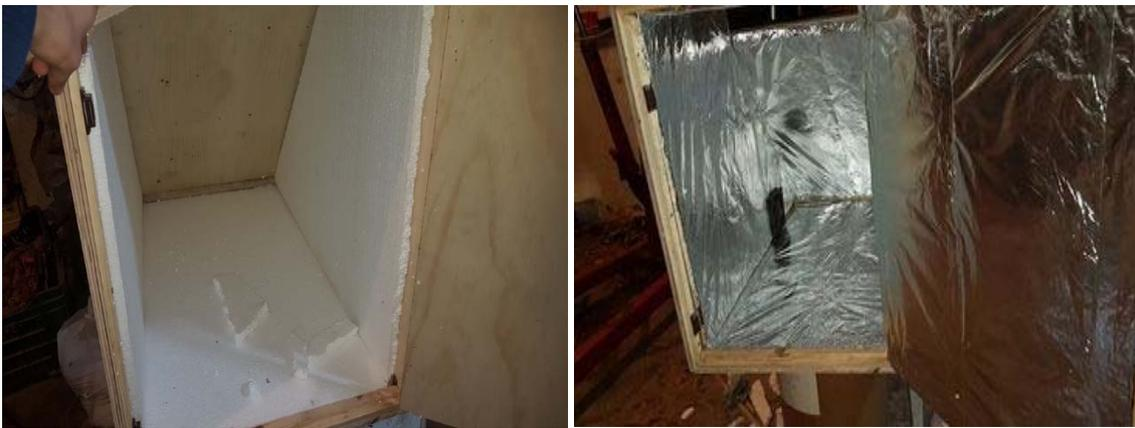
Figure III-24: Peinture et isolation du séchoir solaire.
