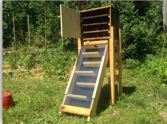
Figure I-17: Séchoir solaire armoire.
