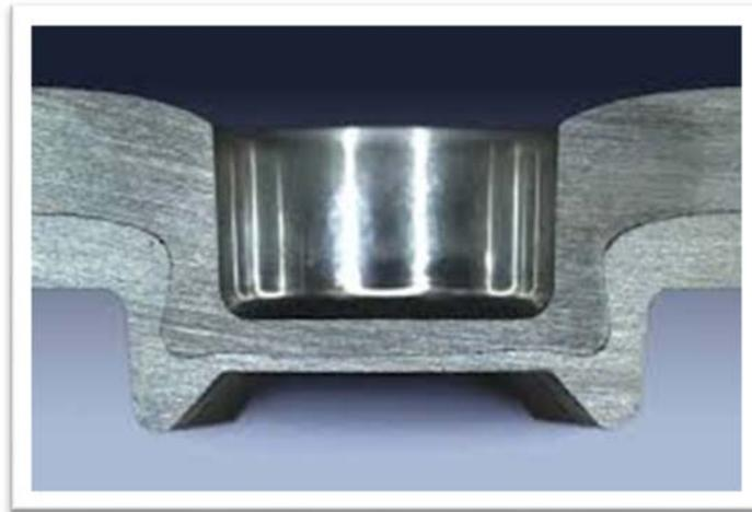
Figure II-8: Micrographie d'un clinch.
