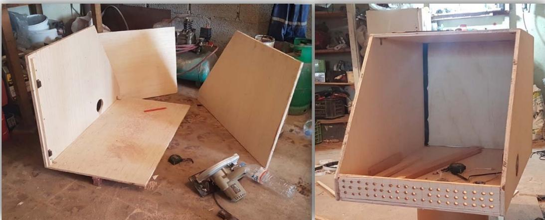
Figure III-23: Assemblage des panneaux du séchoir solaire réalisé.
