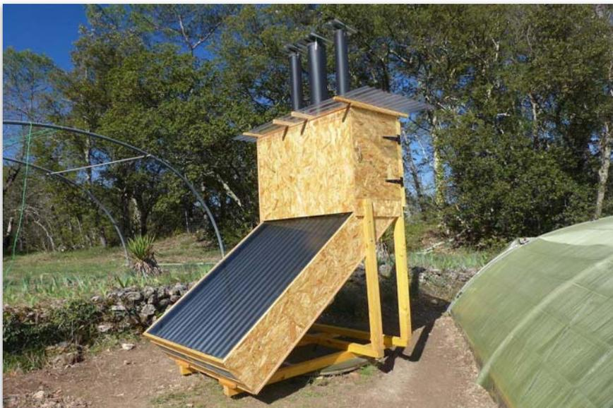
Figure I-1: Illustration d'un séchoir solaire.
