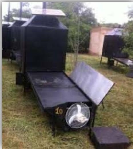
Figure I-21: Séchoir solaire hybride à convection forcée.
