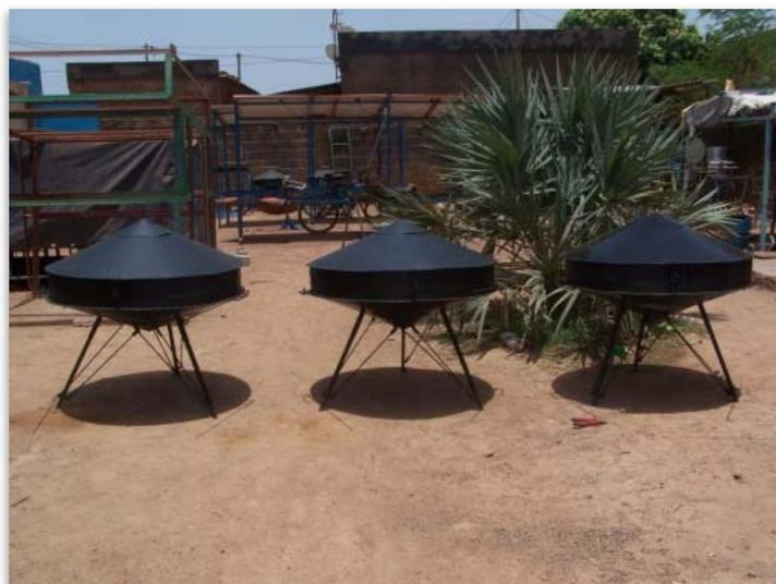
Figure I-14: Le séchoir solaire coquillage à trois claies.
