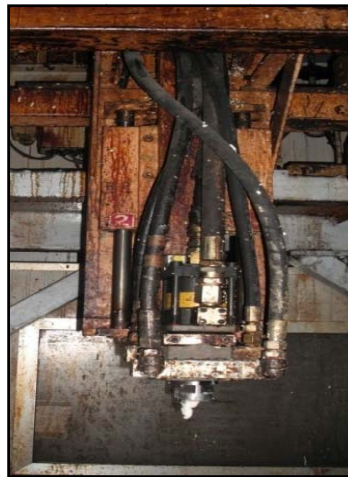
Figure III.22. La machine d'injection de la mousse (utilisée à l'ENIEM)
