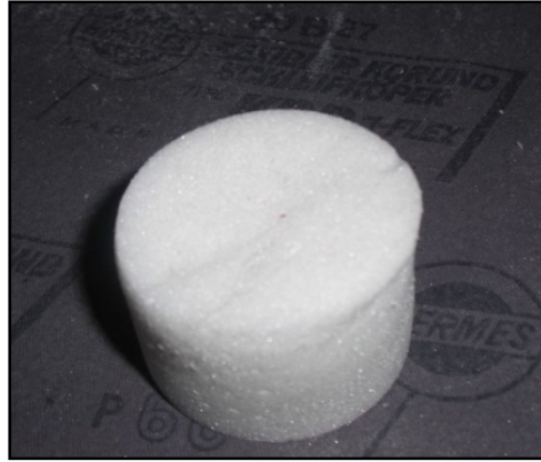
Figure.III.27. Eprouvette cylindrique rétrécie
