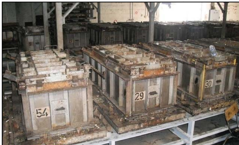
Figure III.23. Les moules de réfrigérateurs utilisés à l'ENIEM
