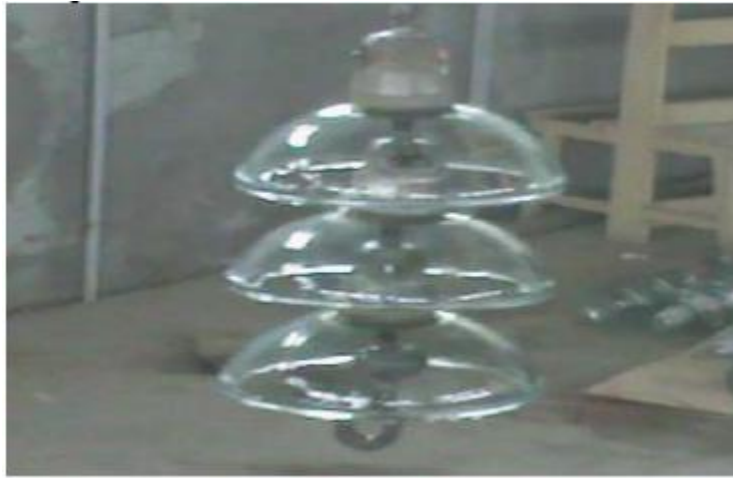
Figure III.4 : Chaine d'isolateurs U120B étudiée
