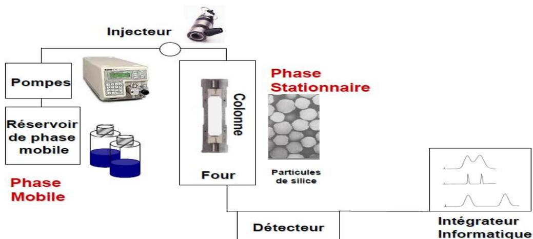
Figure 2 : Schéma d'une installation HPLC [22].
