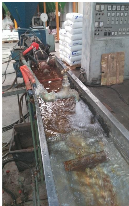
Figure III.6 : L'extrusion des mélanges PMMA/ABS avec l'extrudeuse DELMONICO
