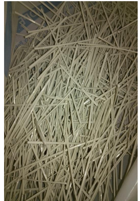
Figure III.6 : L'extrusion des mélanges PMMA/ABS avec l'extrudeuse DELMONICO
