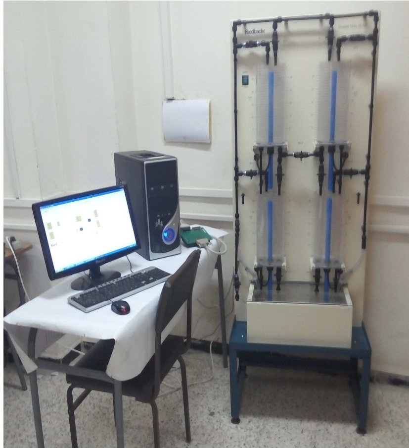
FIG. 5.1: Vue générale du procédé hydraulique à quatre réservoirs relié à un PC
