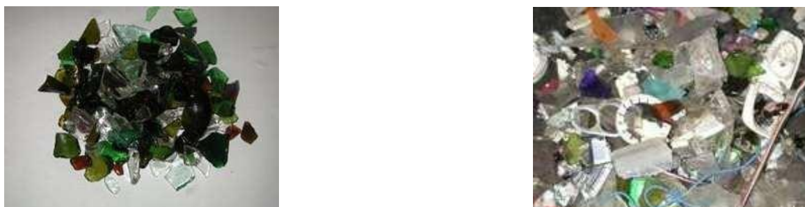
Figure I.7 : a) verre débarrassé des impuretés; b) impuretés du verre (papiers, plastiques, métaux).
