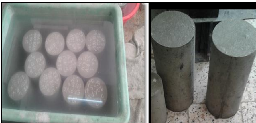
Figure III.15: Conservation des éprouvettes pour 28 j avant écrasement.
