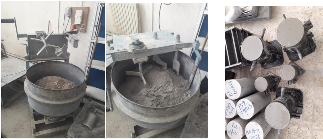
Figure III.14 : confection, moulage et démoulage des éprouvettes.
