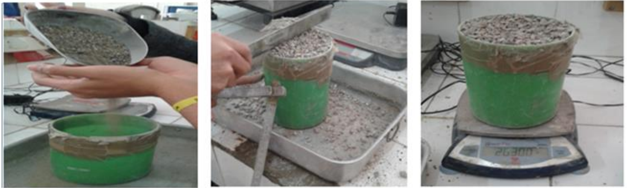
Figure III .10: Essai de la masse volumique.
