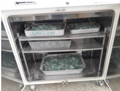
Figure III.6 : Séchage des déchets de verre .
