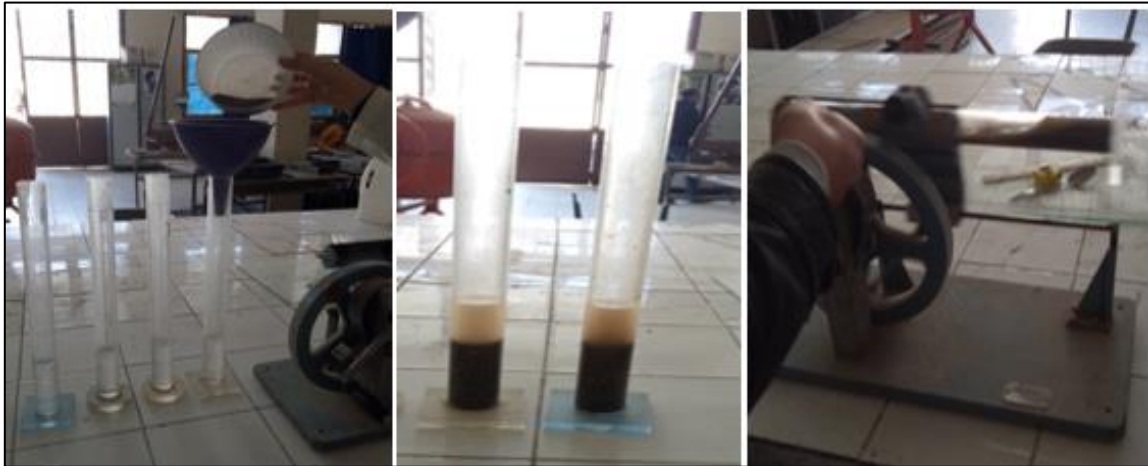
Figure III.11 : L'essai d'équivalent du sable.
