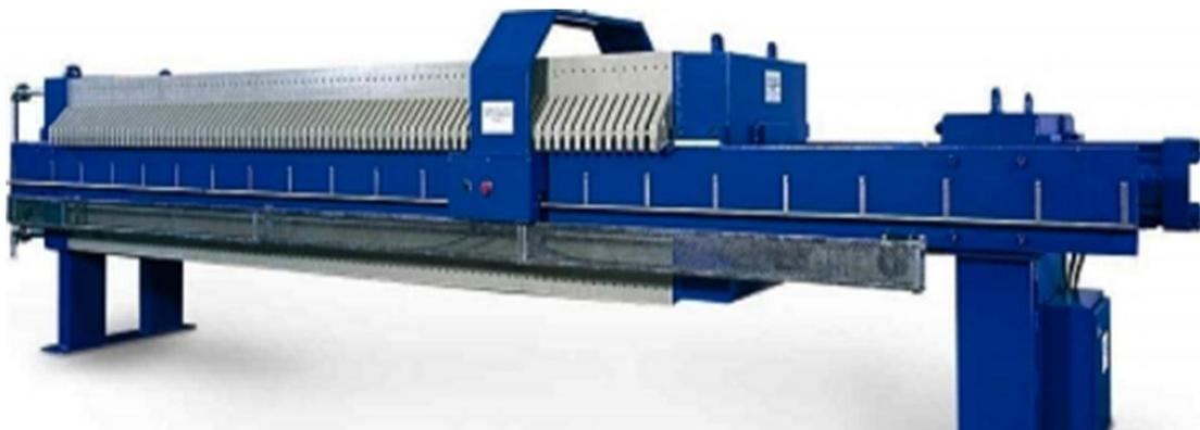
**Figure III.2** : Exemple de filtre presse
