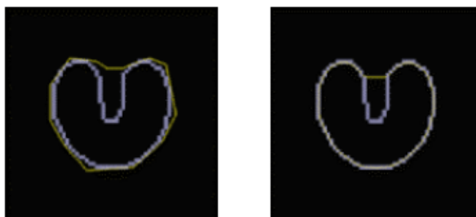
Fig.2.7. Illustration de l'incapacité des snakes à converger vers les concavités.
