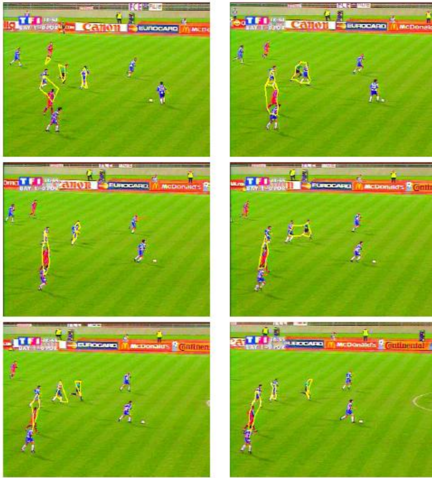
Fig. 2.15. Intérêt des étapes de scission et fusion dans le cas d'objets proches et d'occlusions temporaires [16].
