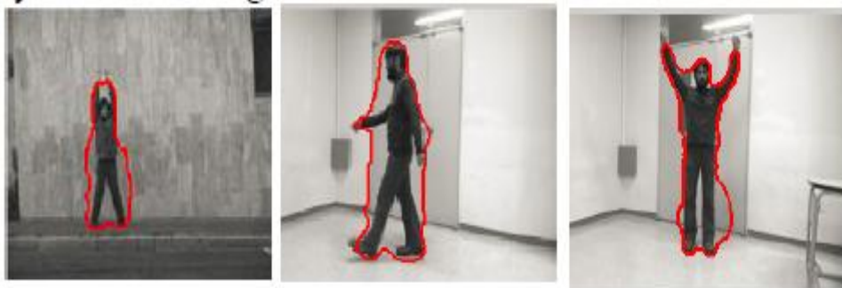
Fig. 2.8. Illustration montrant l'incapacité des snake à segmenter des objet à forme concave.
