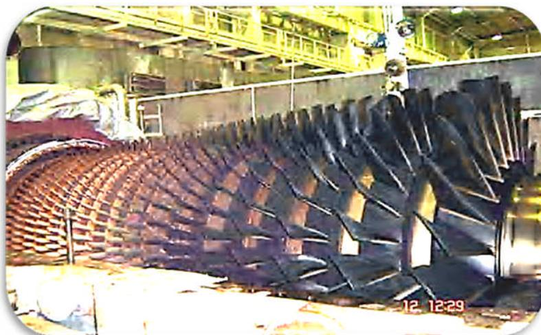
Fig I- 4 : Compresseur de la turbine V94.3A
