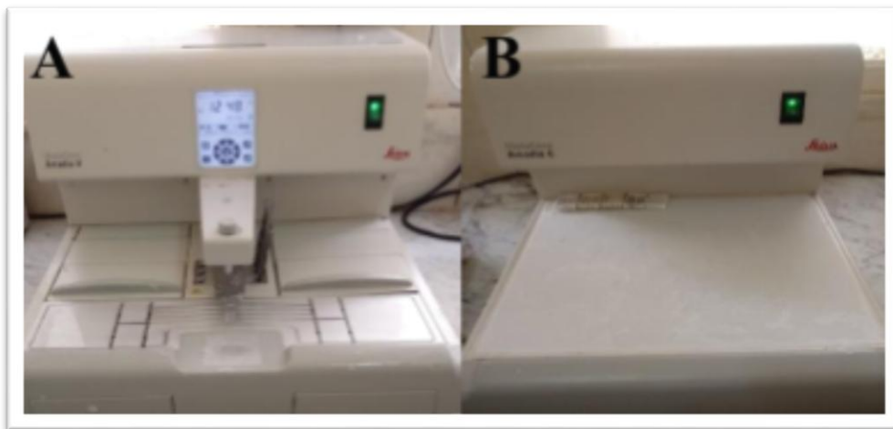
Figure 16 : Photographie montrant l'étape d'inclusion (2019). Appareil d'inclusion (A) ; Solidification des échantillons sur une plaque refroidissante (B).
