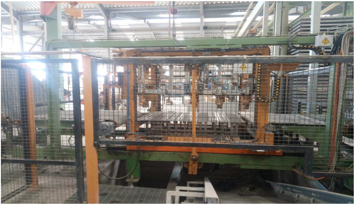
Figure 2.1 : La coupeuse multi fil dans son ensemble
