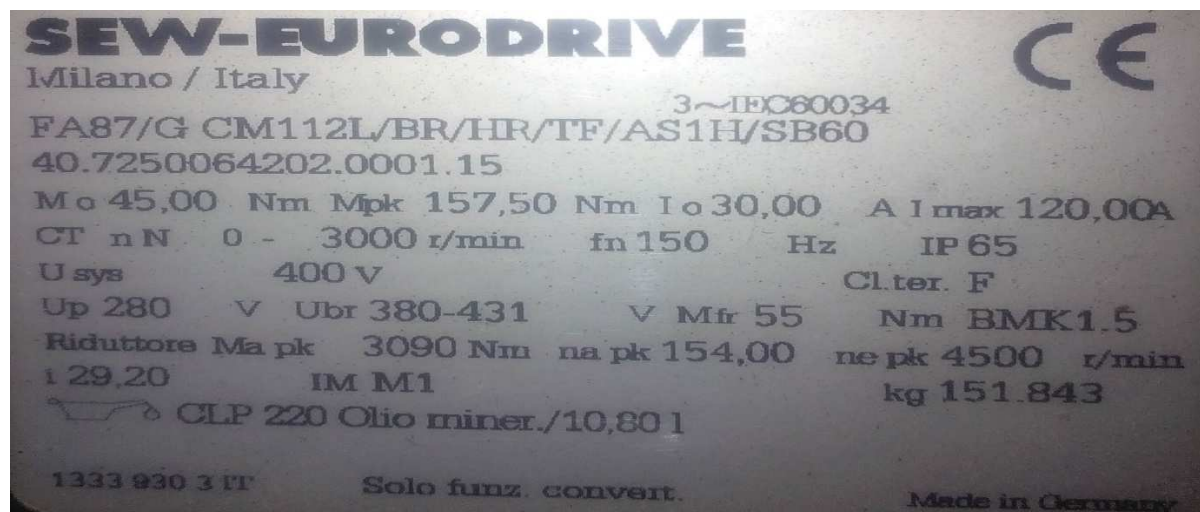
Figure 2.3 : Plaque signalétique du moteur 1
