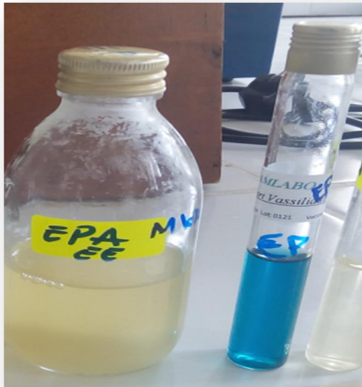
Figure 43: l'enrichissement primaire et secondaire correspondant à la recherche des Salmonelles à 37°C pour l'eau brute et eau épurée dans de l'eau peptonée tamponnée et Rappaport Vassiliadis.
