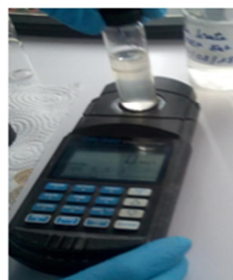
Figure 15 : Schéma représentatif de la technique de mesure des MES
