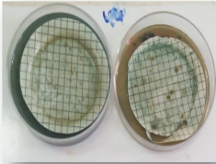
Figure 35 : Représentation des boîtes de pétries correspondant à la recherche des coliformes totaux 37°C pour l'eau brute et eau épurée.
