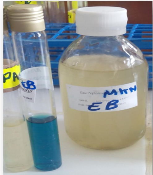
Figure 43: l'enrichissement primaire et secondaire correspondant à la recherche des Salmonelles à 37°C pour l'eau brute et eau épurée dans de l'eau peptonée tamponnée et Rappaport Vassiliadis.
