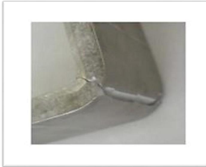
**Figure II. 11** : rupture lors de pliage
