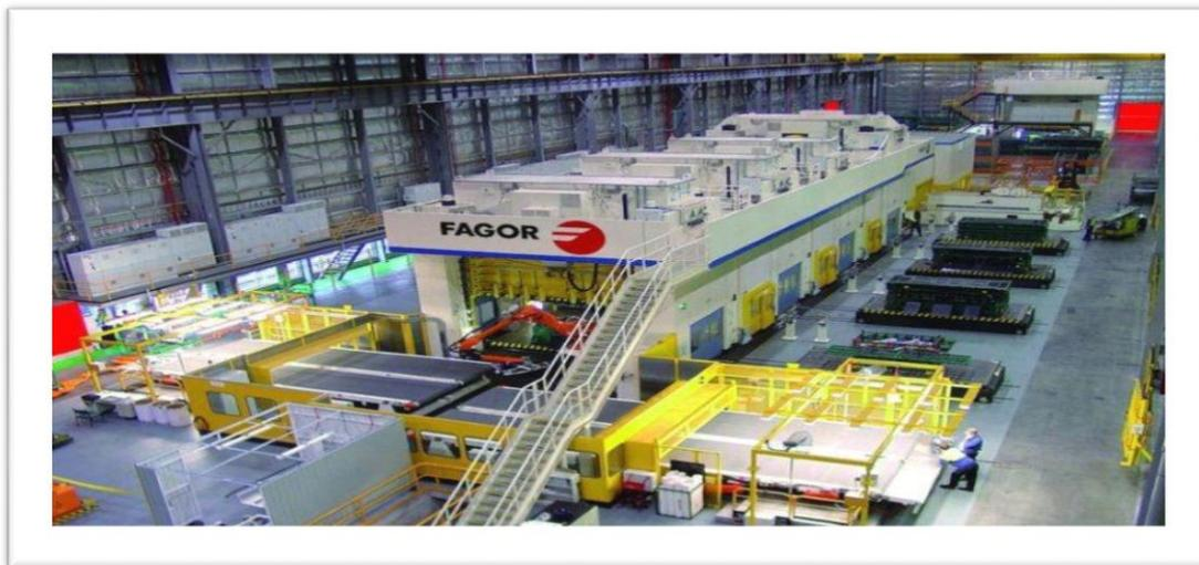
**Figure III.3 :** Ligne de presses d'emboutissage.
