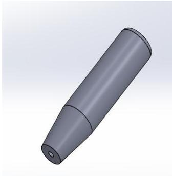
**Figure IV-8 : Colonnes de guidage**
