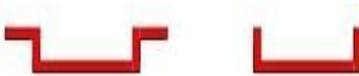
**Figure III-11 :** Étape n°5 : Le détourage de la pièce emboutie
