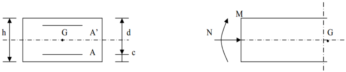
Figure III-2-3 : Section rectangulaire soumise à la flexion composée.
