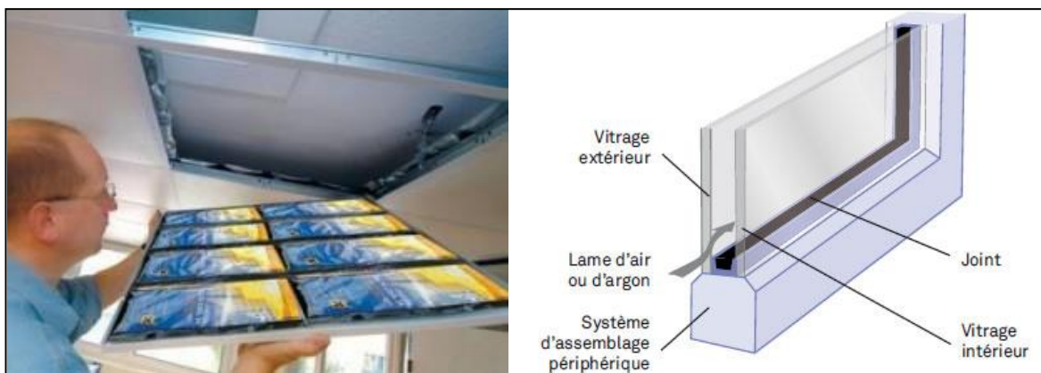
Figure 164 : le double vitrage remplie par un matériau de changement de phase Source : www.wikipedia.org/double_vitrage
