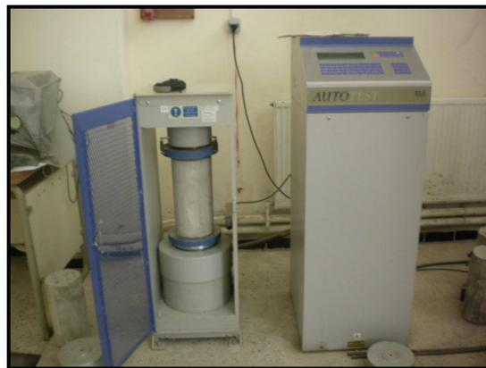
Figure V.5: Machine à compression (presse digitale)
