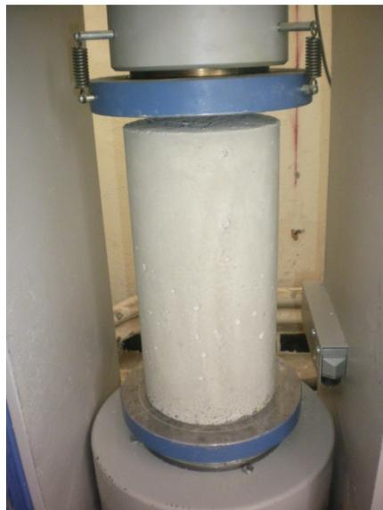
**Figure V.7:** Eprouvette entre les deux plateaux de la presse
