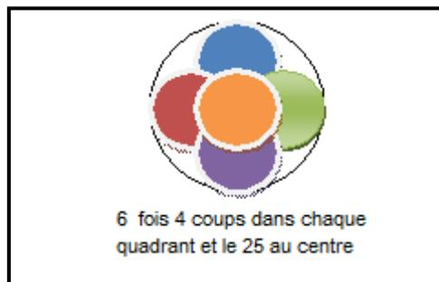
Figure III.6 : Compactage des couches
