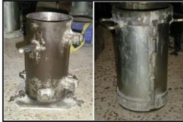
Figure V.4: Moule cylindrique 16\*32
