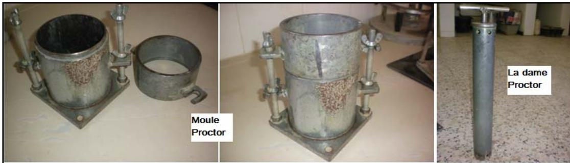
Figure III.5: Equipement de l'essai Proctor normal
