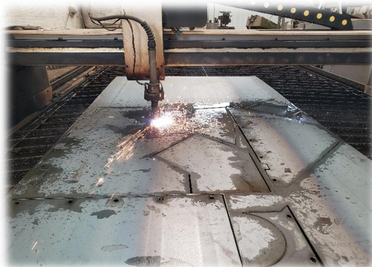
Figure III-2 : La découpe au plasma
