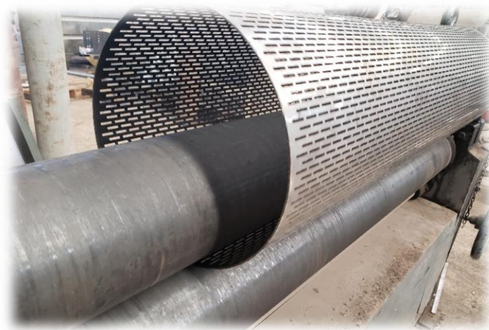
Figure III-5 : Opération de roulage
