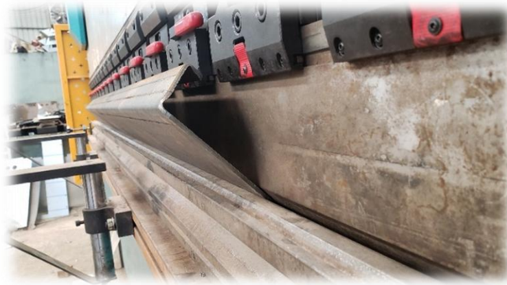
Figure III-4 : Opération de pliage.
