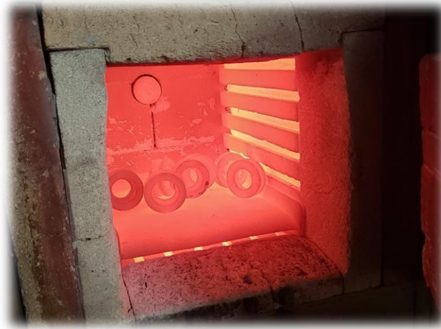
Figure III-13 : Le traitement thermique (la trempe).
