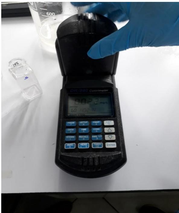
Figure 17 : Mesure des NO<sub>2</sub><sup>-</sup>.
