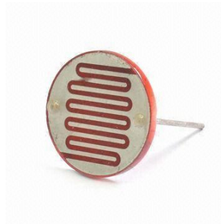
Figure III.5 Symbole et capteur LDR.
