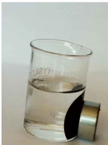
Figure 4: utilisation d'un aimant pour une séparation efficace
