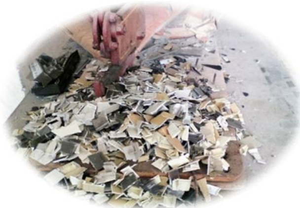
Figure IV.4 : Déchets découpés à la cisaille en petits morceaux avant broyage.
