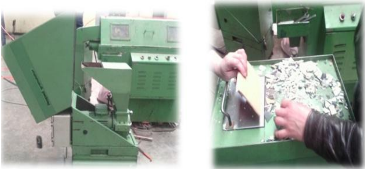
Figure IV .5: Broyages des DEEE au niveau de SICOPLAST Drâa-El-Mizan.
