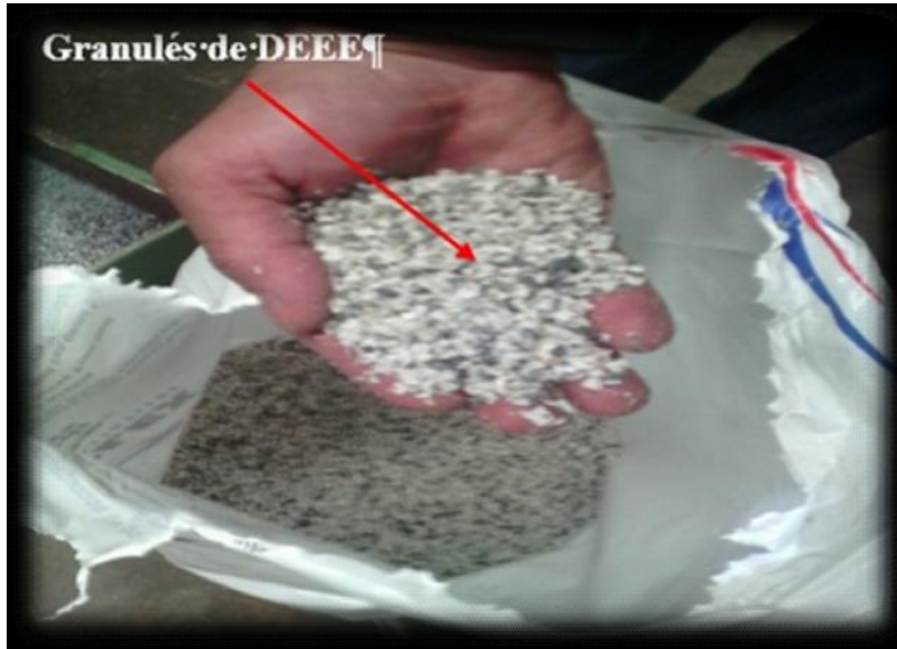
Figure IV.7: Les DEEE à l'état granulaire après le broyage.
