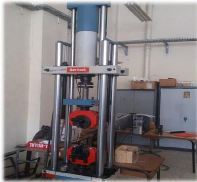
Figure III.2: Machine de traction de Marque IBERTEST au niveau du laboratoire SDM
