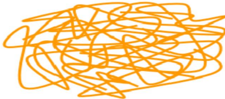
Figure. I.7 : Structure moléculaire des polymères amorphes [4].
