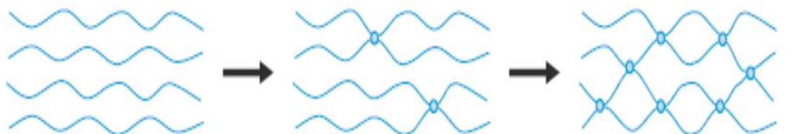
Figure.II.3: Représentation schématique de la réticulation au sein d'un polymère linéaire [33].
