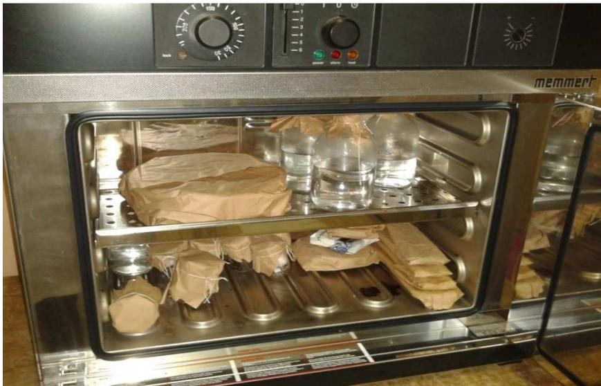
**Figure 15 :** Stérilisation du matériel dans une étuve à 127°c .
