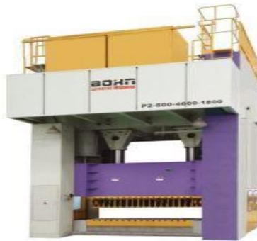
Figure II.8 : figure à montant droit
