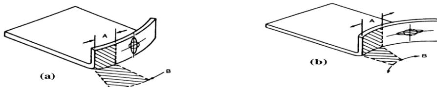
Figure : I.18 : Relevage de bord par : (a) rétreint (b) expansion.
