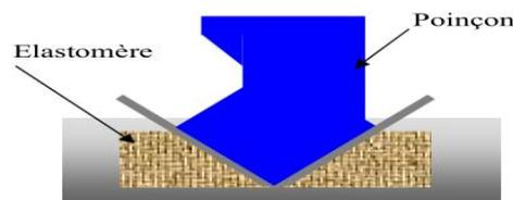
Figure I.31 : pliage sur élastomère
