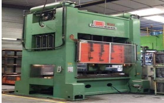
**Figure II.4 : Presse mécanique**
