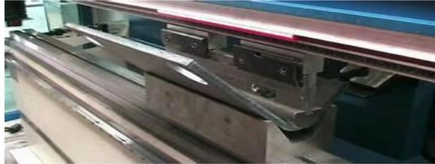
Figure I.28 : Pliage en V
