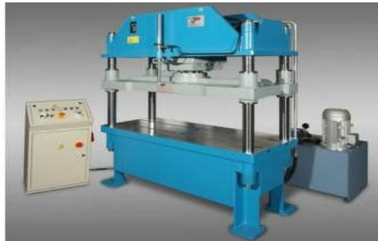
**Figure II.7 : Presse à colonnes.**
