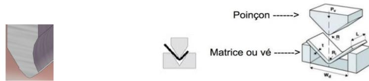
Figure I. 30 : pliage en l'air
