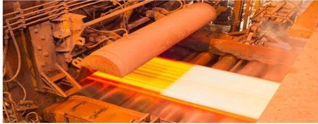
Figure I.3 : Le laminage de la tôle à chaud
