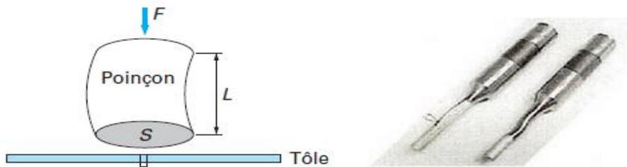
Figure I.16 : Exemple de flambement d'un poinçon de découpage.
