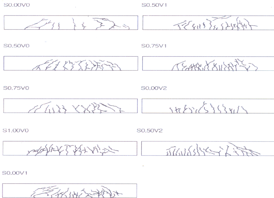
Figure I.24 Mode de fissuration pour les différentes poutres testées [14].
