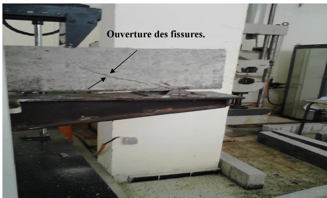
Figure IV. 17 Ouverture de fissure diagonale pour une force F= 94.03 KN.
