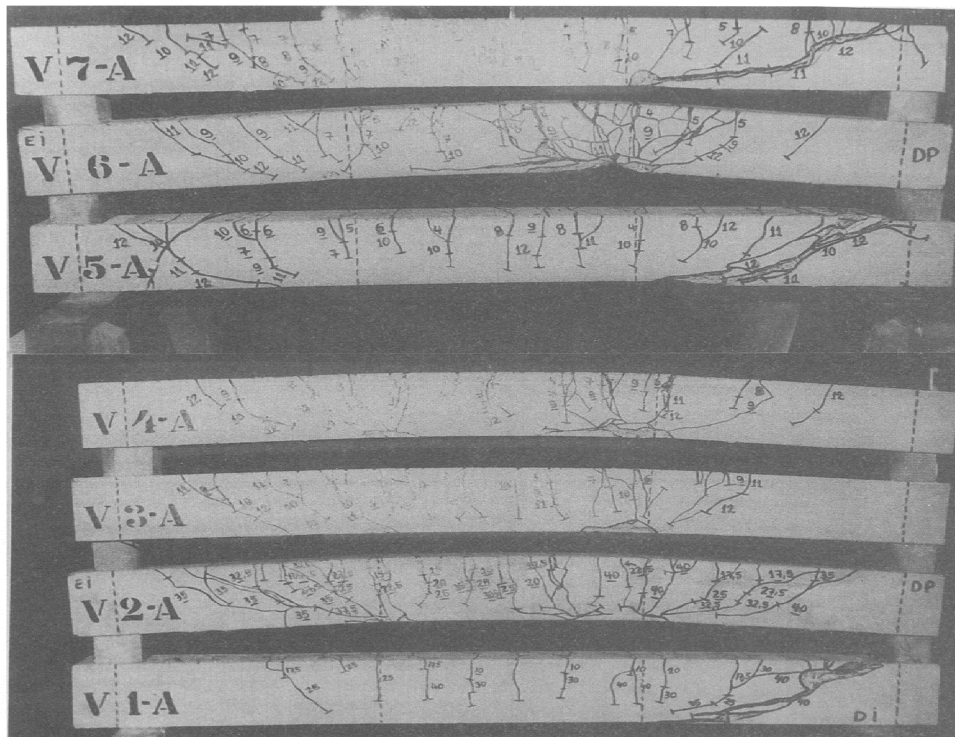
Figure I.16 Vue des poutres série A après les essais [14].
