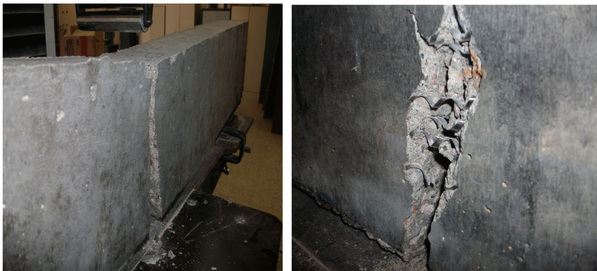
Figure IV.8 Exemple du mode de rupture des poutres lors des essais flexion 3-points.
