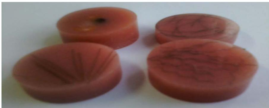
*Figure IV.3 : Echantillons coupés et enrobés.*
