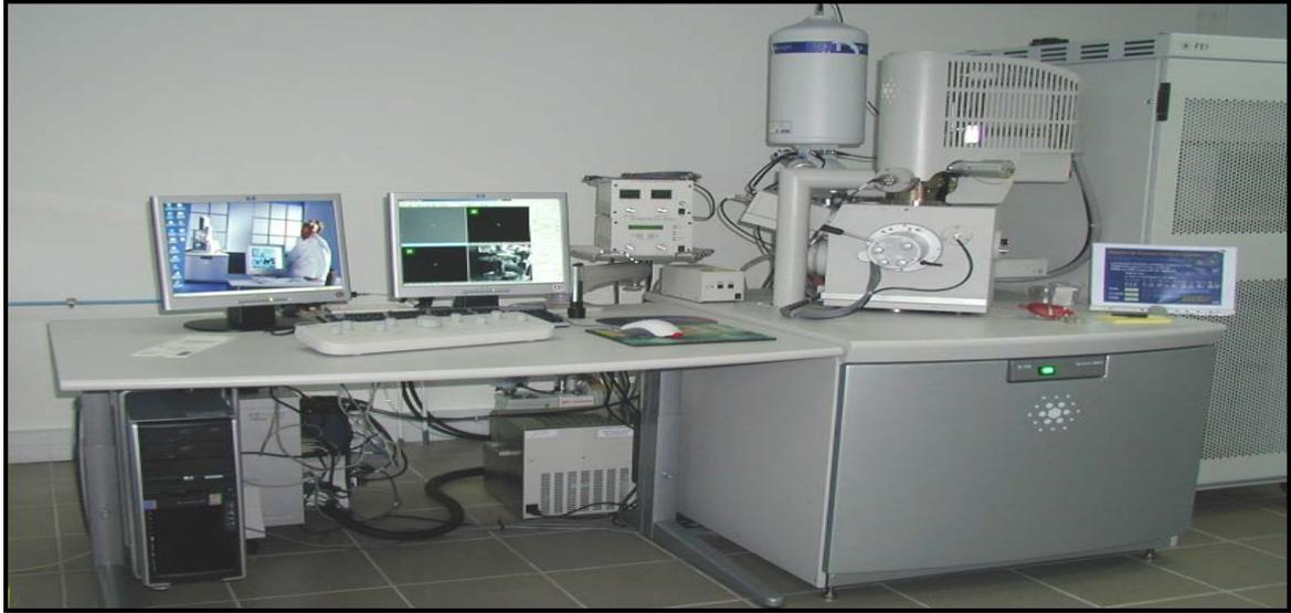
*Figure IV.6 : Microscope électronique à balayage (MEB).*
