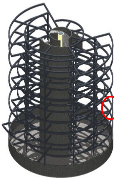
Figure 55 Système constructif de la tour
