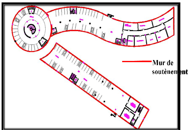
Figure 53 : mur de soutènement
