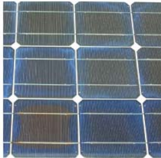
Figure I-21: Dégradation observée pour un module solaire (SIEMENS M55) après 18 ans [46].
