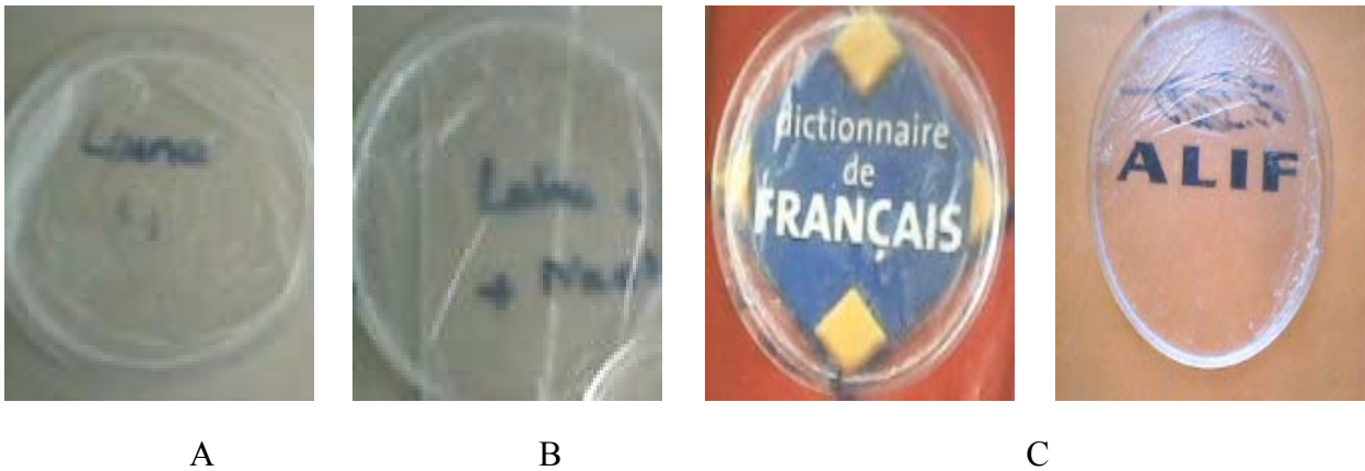
Figure IV-21: Les films obtenus après séchage à 8 °C: A) laine pure, B) laine dégraissée et C) laine oxydée
