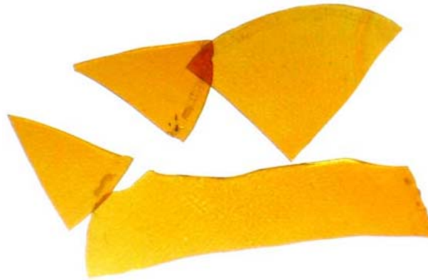
Figure III-12: Film obtenu par thermo-compression des granulés de laine oxydée régénérée [51].
