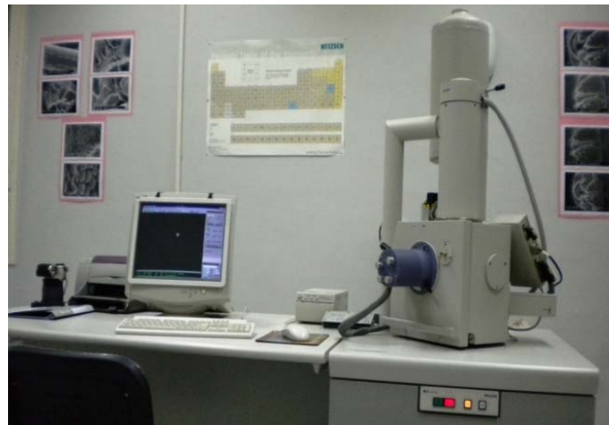
Figure IV-3: Le microscope électronique à balayage PHILLIPS ESEM XL 30.
