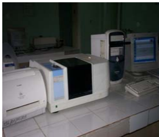
Figure IV-13: La spectroscopie IR-8400 SHIMADZU.
