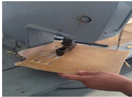
Figure 20 : Appareil mécanique utilisé pour l'obtention des éprouvettes H.
