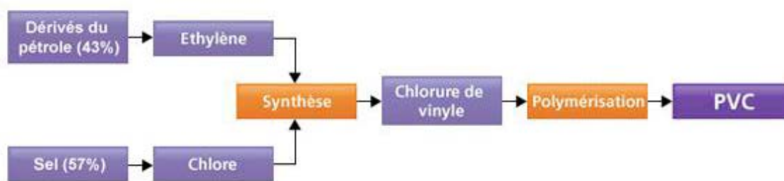
Figure 10 : Schéma de fabrication du composant de base : la résine PV ou compound [37].
