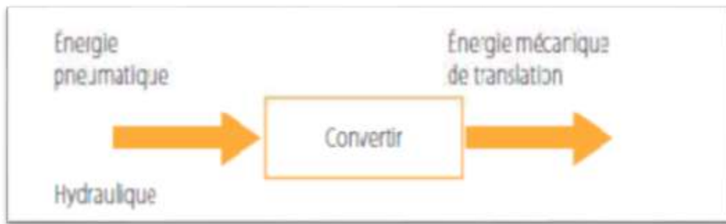
Figure 10 : transfert d'énergie d'un vérin.
