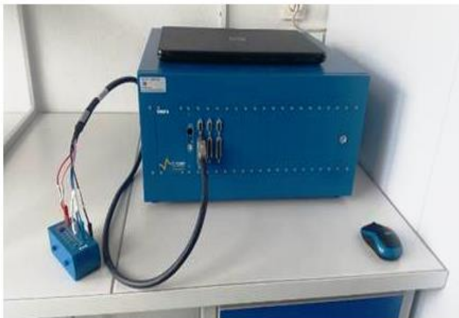
Figure II.5 : Potentiostat VMP-3 pour la spectroscopie d'impédance
