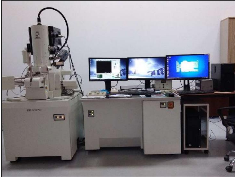
Figure II.9 : Microscope Electronique à Balayage (MEB) de type JSM-7610F Plus (CRTSE)
